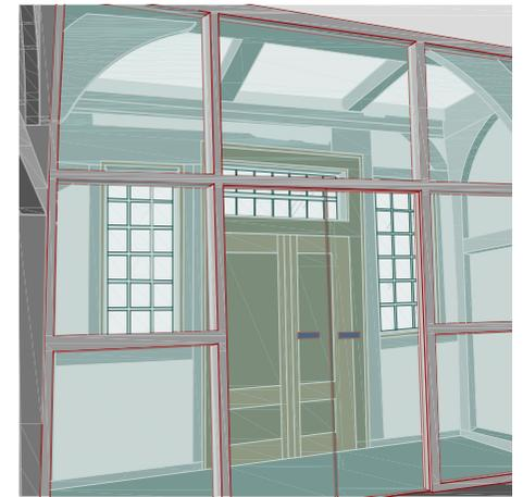
Visualisierung eines möglichen modernen Windfangs im Eingangsbereich aus Glas.
